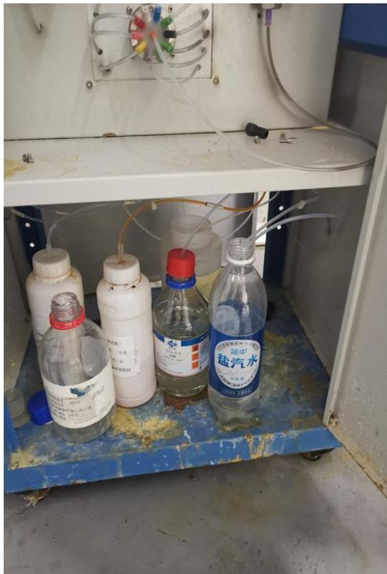
2021年9月5日，执法人员检查某公司时发现，该公司及其运维机构将CODCr在线监测仪器取样管路从水处理设施排放口断开，连接在一装自来水的塑料瓶内，使COD<sub>Cr</sub>在线监测仪器采集与分析的水样为塑料瓶内水。根据生态环境部《环境监测数据弄虚作假行为判定及处理办法》有关规定，该公司在自动监测设施采样环节弄虚作假，造成在线监测数据失真，属于典型的篡改监测数据行为。该行为违反了最高人民法院、最高人民检察院关于办理环境污染刑事案件适用法律若干问题的解释（法释〔2016〕29号）第一条第（七）项规定，已涉嫌污染环境罪。根据行刑衔接规定，青浦区生态环境局已将当事人及其运维机构违法行为移送公安机关进一步侦办。
