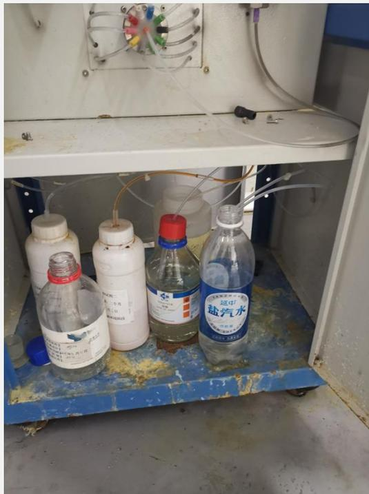
2021年9月5日，执法人员检查某公司时发现，该公司及其运维机构将COD<sub>Cr</sub>在线监测仪器取样管路从水处理设施排放口断开，连接在一装自来水的塑料瓶内，使COD<sub>Cr</sub>在线监测仪器采集与分析的水样为塑料瓶内水。根据生态环境部《环境监测数据弄虚作假行为判定及处理办法》有关规定，该公司在自动监测设施采样环节弄虚作假，造成在线监测数据失真，属于典型的篡改监测数据行为。该行为违反了最高人民法院、最高人民检察院关于办理环境污染刑事案件适用法律若干问题的解释（法释〔2016〕29号）第一条第（七）项规定，已涉嫌污染环境罪。根据行刑衔接规定，青浦区生态环境局已将当事人及其运维机构违法行为移送公安机关进一步侦办。
